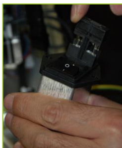
Figura 12 Illustrazione operazione di estrazione e sostituzione fusibili
