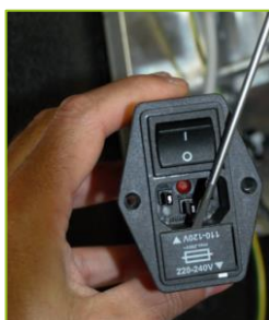
Figura 11 Illustrazione operazione di apertura sportello fusibili
